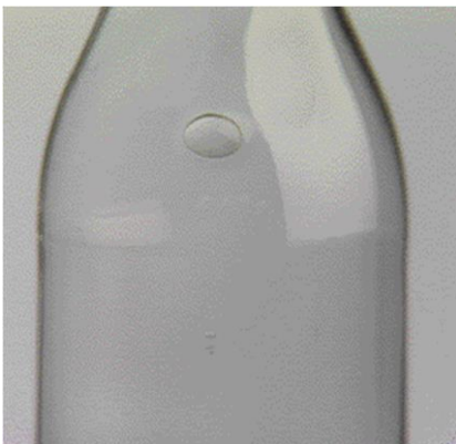
Figura 79 – Bolha (defeito crítico).
